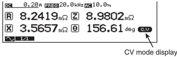
Fig. 4-10 CV mode display
