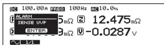
Fig. 4-15 Alarm message display example
